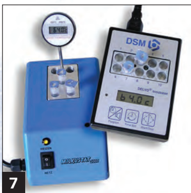
7 Teströhrchen in Heizblock stellen. (wenn Kontrolllampe blinkt bzw. bei DSM-Block 64° Celsius auf Display)
